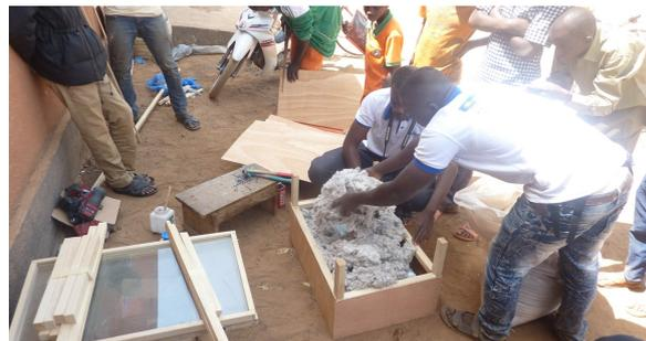
Le matériel étant coupé il fallait assembler ces pièces, les coller et les clouer ensemble. Pour éviter que le bois brûle, il y a de l'isolation (coton) compressé sous le bac. Toutes les pièces sont clouées et non visées à cause de la fragilité du bois pour qu'il n'éclate pas. Il y a une couverture en vitre sur le châssis ainsi qu'un panneau réflecteur.
